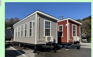
トレーラーハウス（設置例）
